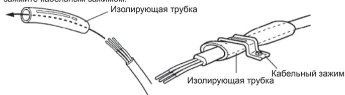
В качестве изолирующей трубки используйте трубку VW-1 из ПВХ толщиной 1,0 мм.
